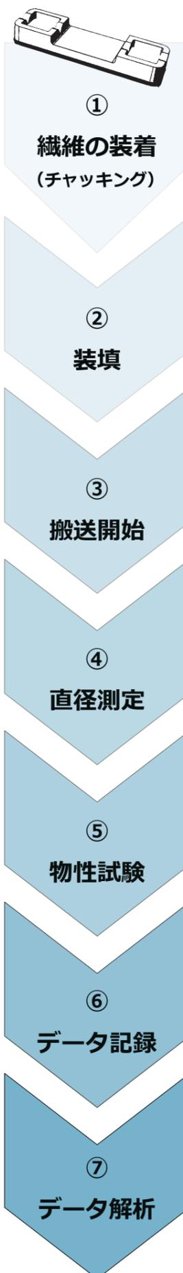
従来行われていたチャッキングに代わる作業です。プラスチック製タブを1本の繊維に2つ使用します。タブ中央部分のV字型のミゾに繊維の片端を入れ、UV瞬間接着剤で固定します。同様の接着を繊維の片側にも行うことで装着は終了です。
