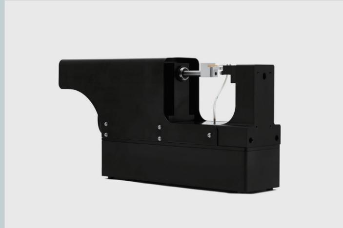
本体の心臓部分には高精度のDCマイクロメータードライブが組み込まれておりスムーズな試料の移動を可能にします。これにより反復しての位置決め高精度で行うことができます。なお一連の試験は以下の基準を準拠しています。
