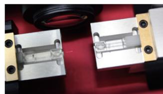
サンプルにタルミ等があれば試験前に自動でプレテンションをかけ除去します。設定により引っ張り破壊、緩和、伸長モード（弾性）等試験を実行します。
