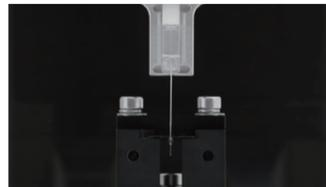
ビデオ取り込み用ソフトと制御ソフトUvWinを起動、ビデオ取り込みの設定を選択します。繊維や液滴のサイズが校正済みのカメラシステムにより測定されます。
