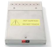
プローブの自動赤熱洗浄に使用する内蔵ユニットです。使用頻度・状況により定期的な交換が必要です。汚染リスクも解消します。400プレート程度の耐用回数があります。
