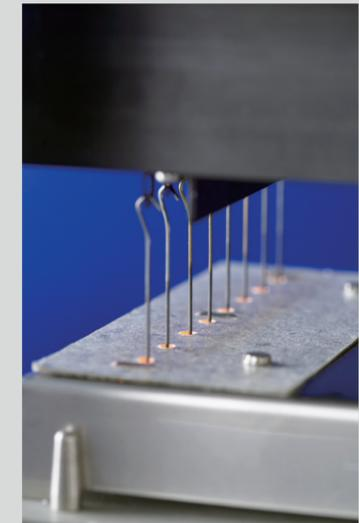
測定毎に内蔵のDyneClean（トースター）で8つのプローブを自動で赤熱洗浄します。
