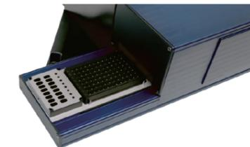
Delta-8で液洗浄を可能にするType-Bの設定で使用する洗浄用のトレイです。水やエタノールを注入できるスロットを3列xプローブ用のウェル8個を各列の配置。エタノールの蒸発を防ぐ着脱可能な金属製の蓋を備えます。
